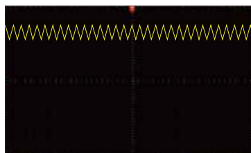
DC+AC Vdc=50V, 三角波形纹波 Vac=5V, 频率 1000Hz
